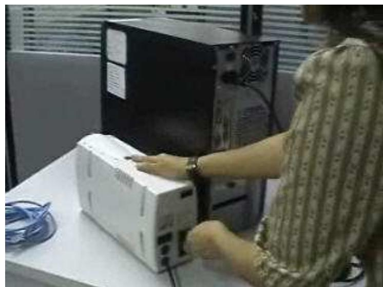
2. เสียบสาย LAN เข้ากับเครื่องคอมพิวเตอร์แม่ข่ายและนำไปเชื่อมต่อกับระบบเครือข่ายของทางโรงเรียน โดยการนำปลายสายอีกข้างเสียบเข้ากับ Switch หรือ Hub ที่ใช้งานเชื่อมต่อกับเครื่องคอมพิวเตอร์เครื่องอื่นๆ ภายในโรงเรียน (Switch หรือ Hub ทำหน้าที่เป็นศูนย์รวมในการสื่อสาร รับ ส่ง และกระจายสัญญาณ ระหว่างเครื่องคอมพิวเตอร์แต่ละเครื่อง ในระบบเครือข่าย)
